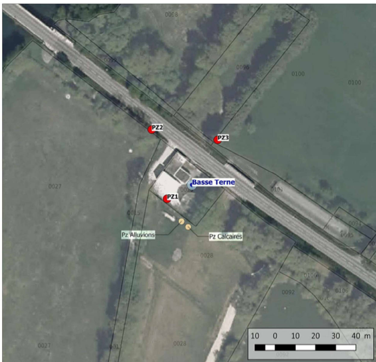
Figure 8 : Localisation des piézomètres autour du puits de Basse Terne : en rouge les piézomètres préexistants, en jaune les nouveaux piézomètres créés en 2017
